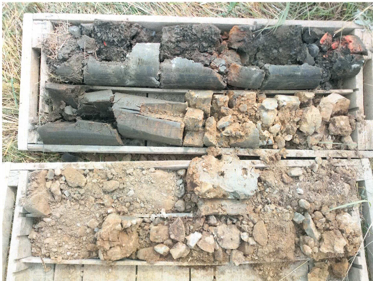
Foto 1: Fotodokumentace jádrového vrtu. 0,0m vlevo nahoře; 4,0m pod terénem vpravo dole.
